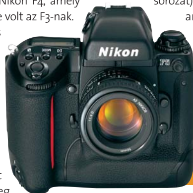
Az 1996-ban bejelentett F5 akár 8 kép/s-os sorozatfelvételi sebességre képes, ötmezős élességállítási rendszerrel és 3D Color Matrix fényméréssel rendelkezik. Tömege akku és objektív nélkül 1,2 kg.
